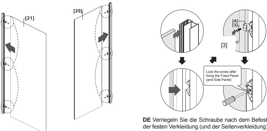
**DE** Verriegeln Sie die Schraube nach dem Befestigen der festen Verkleidung (und der Seitenverkleidung). **FR** Verrouillez la vis après avoir fixé le panneau fixe (et le panneau latéral) **HU** A rögzített panel (és az oldalsó panel) rögzítése után rögzítse a csavart **RO** Blocăți surubul după fixarea panouului fix (și a panoului lateral)
